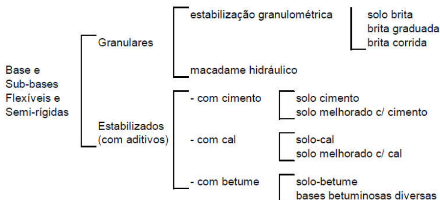
Figura 4 – Classificação das bases e sub-bases.
